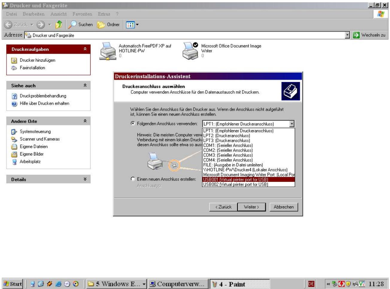
In dem Dropdownmenue können Sie auswählen, an welchem Anschluss das Gerät mit dem Computer verbunden ist. In unserem Fall wählen wir den USB Port. >Weiter>
