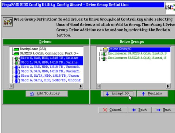
Die Festplatten in den Slots 0 und 1 mit "Add To Array" der Drivegroup0 zuweisen.
